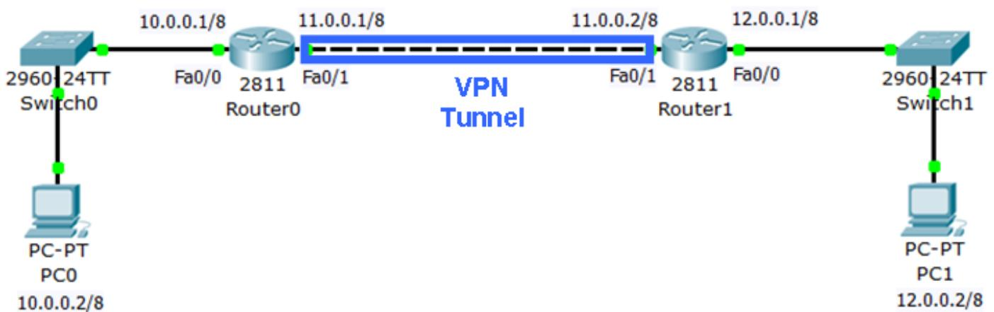
**Phase 1** : spécification des algorithmes de chiffrement, et de hashage, du type de clé utilisée pour s'authentifier, du groupe Diffie-Helman, et création de la clé "mère" utilisée pour l'authentification (et à partir de laquelle seront générées les clés de chiffrement).
