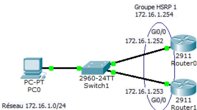
HSRP (Hot Standby Routing Protocol) est un protocole propriétaire Cisco qui permet de créer un routeur virtuel à partir de deux routeurs physiques.
