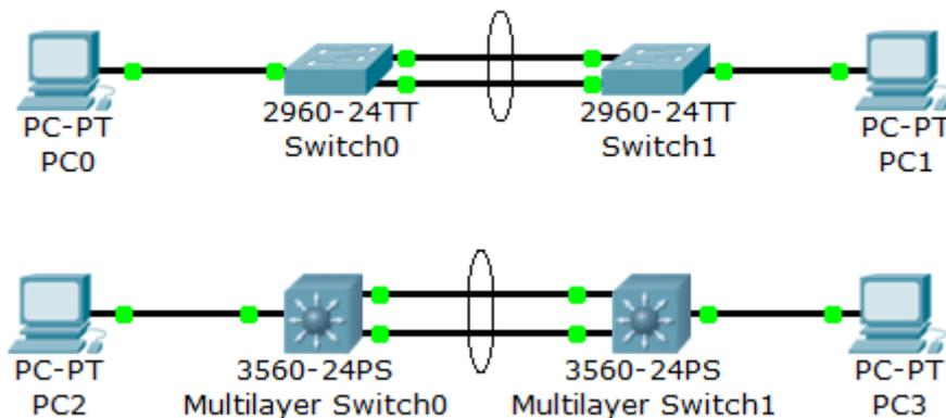
Il s'agit de créer une agrégation de liens (regroupement de plusieurs ports physiques pour créer un port logique (PortChannelx, x étant le numéro du port logique)) à partir de deux liens Gi1/1-Gi1/1 et Gi1/2-Gi1/2.
